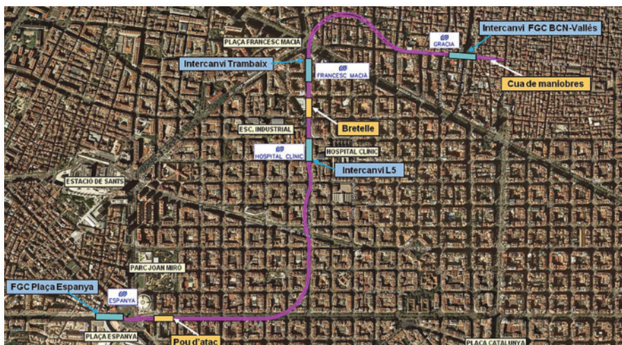
Ortofoto de Barcelona con la traza de la prolongación, desde Plaza España hasta la estación de Gracia
