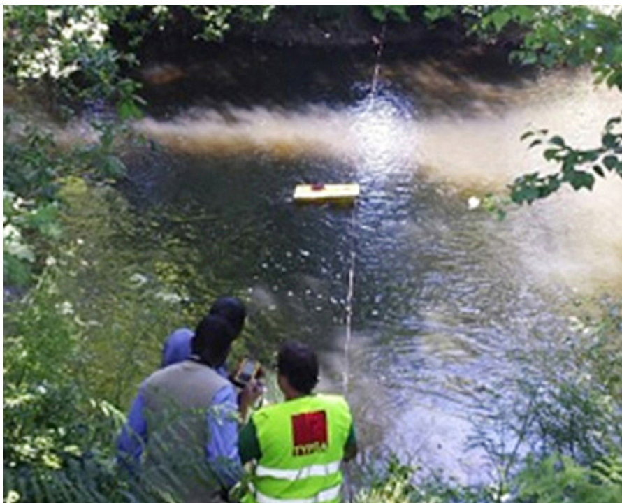
Personal de la ARA-Norte efectuando un aforo directo con el Qliner2 (OTT)
