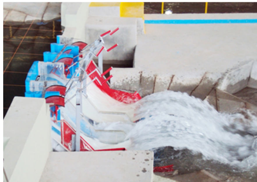
Modelo reducido de la presa
