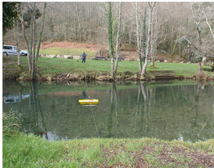
Realización de aforo en el río Sor con el nuevo equipo
