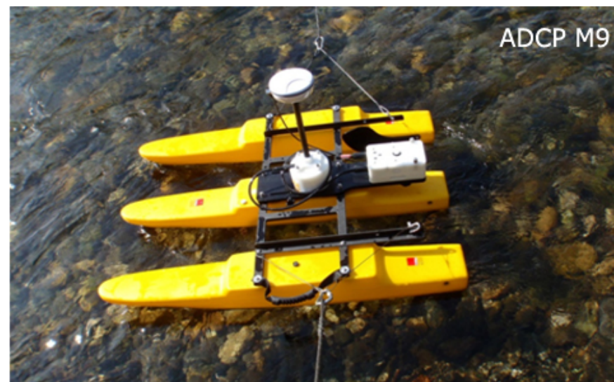
Aforo con RiverSurveyor M9 sobre trimarán Oceanscience
