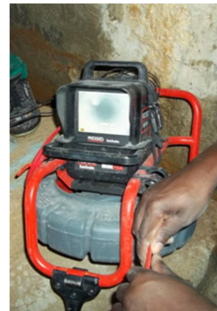
Ejecución de red piezométrica y cámara de video utilizada para grabar el contacto presa-cimiento en Villar de Plasencia (Cáceres)
