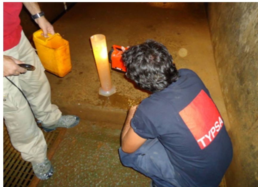
Aforo de caudal en la presa de Jerte (Plasencia)
