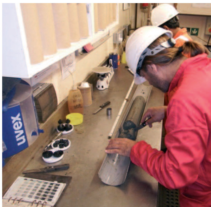
Testificación de sondeo y realización de ensayos in situ por parte de personal del departamento de geotecnia
