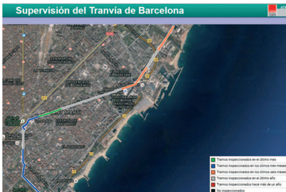
Distinguiendo por colores la fecha de la última inspección, nos informa de los siguientes tramos a inspeccionar
