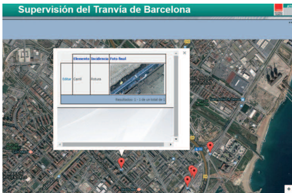
Búsqueda ejemplo de incidencias tipo grieta en carril y nos las ubica sobre plano
