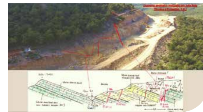
Interpretación modelo geológico boca norte túnel
