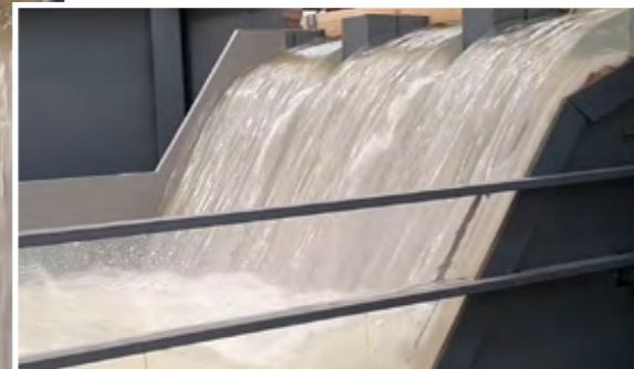
Detalle de simulación de fallo de compuerta en vano central del aliviadero principal. La seguridad de la presa queda garantizada.
