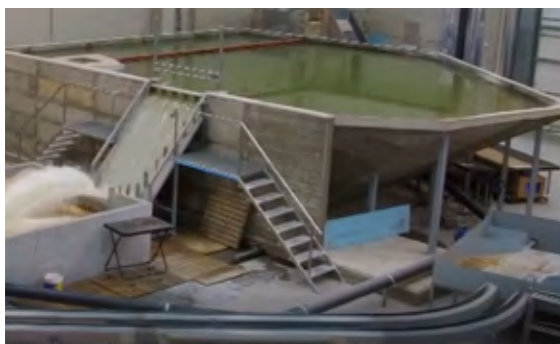
Presa de Carrizal: ensayo de aliviadero en trampolín y desvío del río. La altura de presa es de 160 m y el caudal aliviado de 6.000 m³/s.
