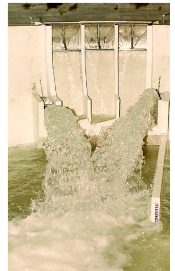
Presa bóveda de Alqueva. Trampolín con cajeros convergentes y solera de radio y ángulo de lanzamiento variable para evitar el impacto en la central hidroeléctrica.
