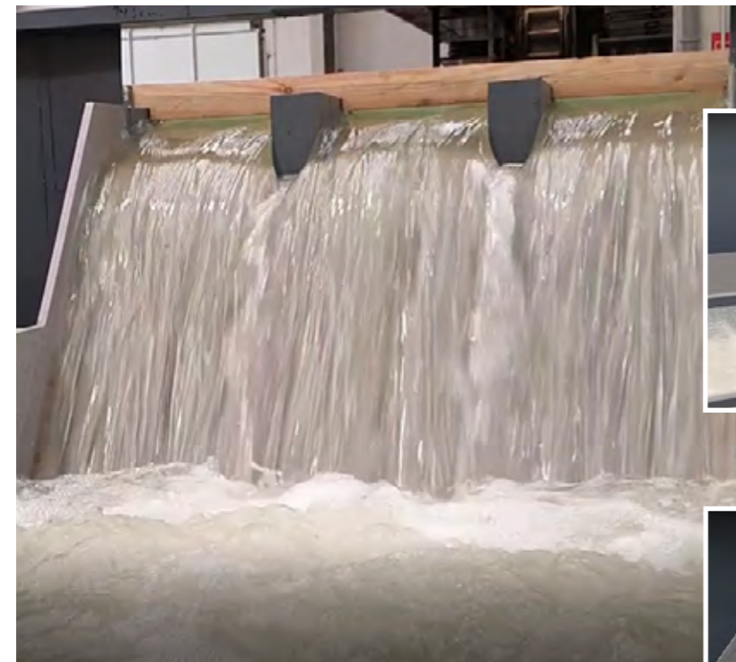
Vista de detalle del aliviadero principal y de la macroturbulencia generada en el resalto hidráulico. Se puede apreciar el vórtice creado al pie de la presa, con un flujo en forma de rodillo que gira en sentido horario.
