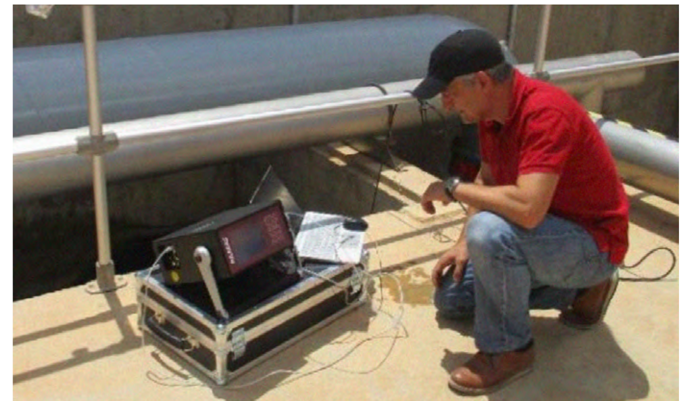
Medición en campo del tamaño y distribución de partículas en un tratamiento terciario
