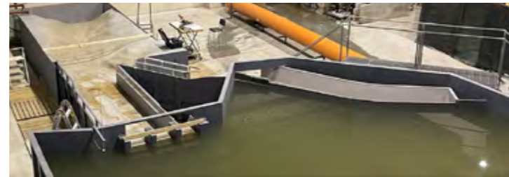
Modelo en vacío visto desde aguas arriba. A la izquierda la presa principal y a la derecha el aliviadero de embocadura lateral.
